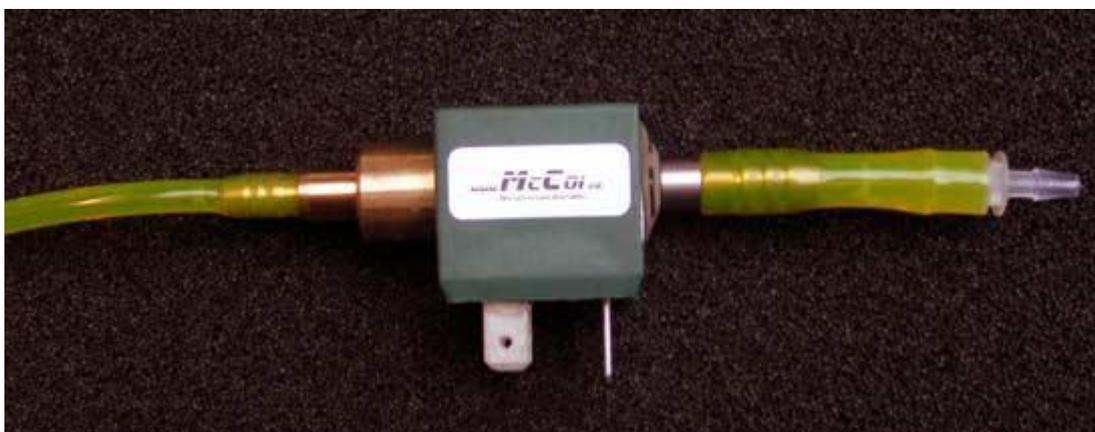
Der Adapter für den Übergang zum dünneren Schlauch wird ebenfalls aufgeschoben und muß nicht mit Kabelbindern fixiert werden. Wer das dennoch machen möchte, achte bitte auch hierbei auf einen
