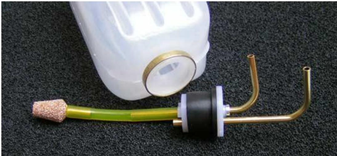
Bevor man den Stopfen mit den Messingröhrchen in den Tank setzt, wird noch die Schraube und die Mutter in der Mitte befestigt. Zieht man nun die Schraube an, quetscht sich der schwarze Stopfen nach außen an den Falschenhals und dichtet diesen ab. Um ein Ausreißen des Falschenhalses zu verhindern, ist auf einen geraden Sitz des Messingbandes am Flaschenhals zu achten!
